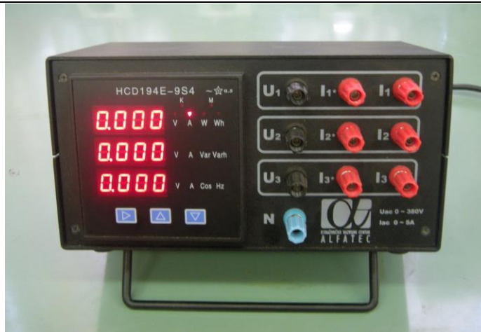
Слика 1. Изглед прототипа дигиталног лабораторијског мрежног анализатора
