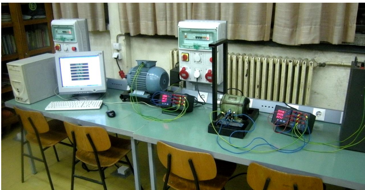
Slika 3. Dvokanalni sistem za akviziciju zasnovan na primeni AWM softvera i DLMA
